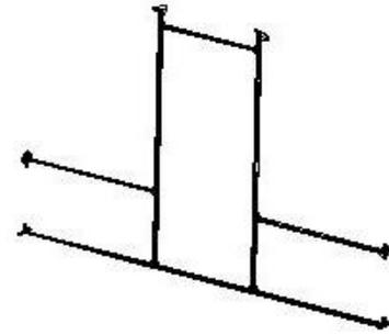
3. Грунтозацепы- для установки теплицы непосредственно на грунт без использования фундамента.
