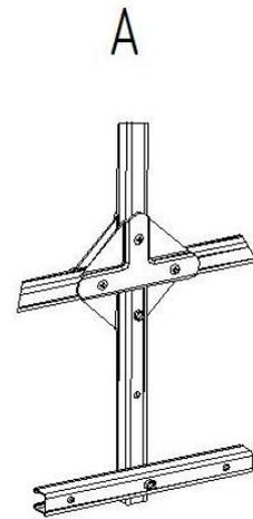
4. Усилители арки. Предназначены для усиления каркаса теплицы в зимний период.
